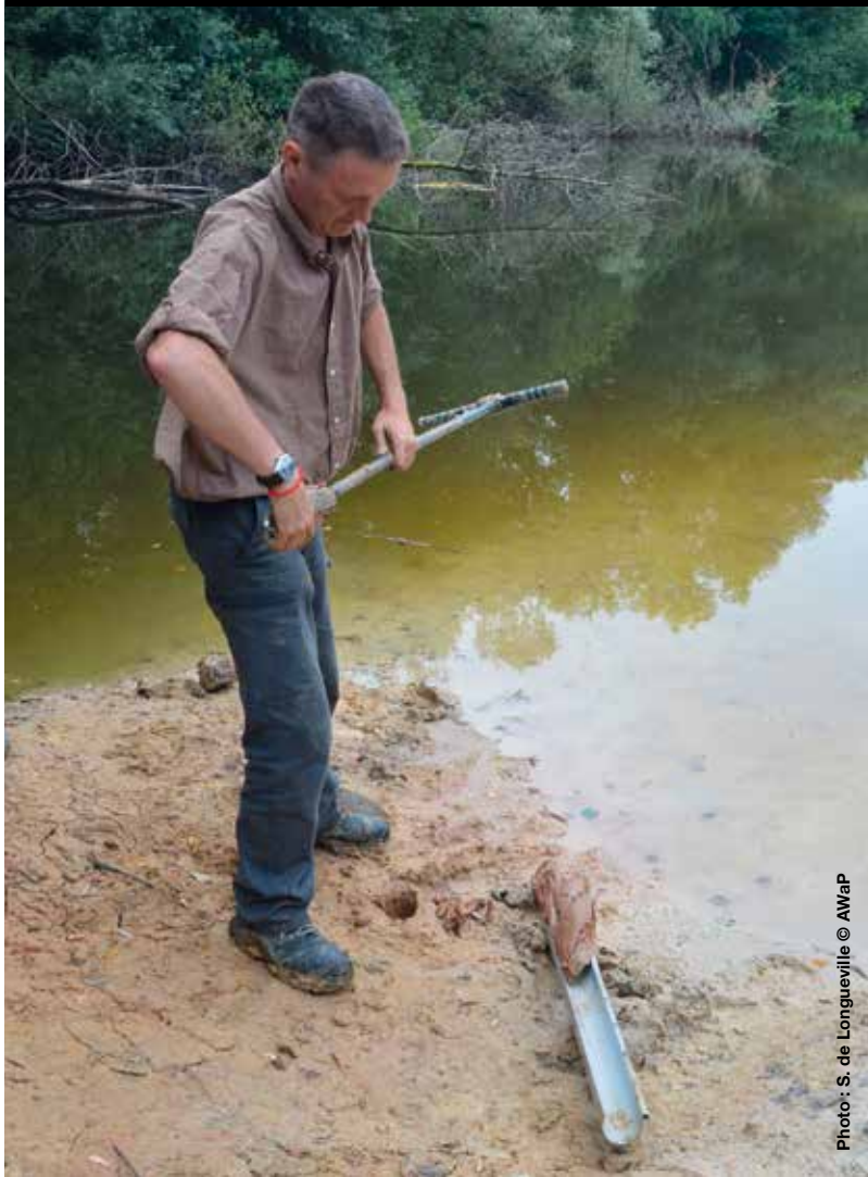
Prélèvement de l'argile locale par carottage
