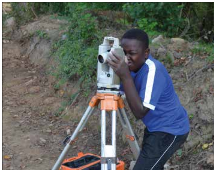
A la découverte des outils de l'archéologue : le théodolite
