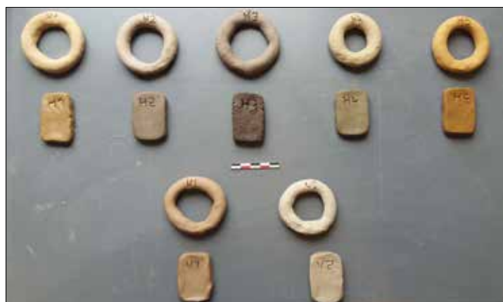
Echantillonnage de différentes argiles de Haillot et de Vaudaigle. Plaquettes en argiles fraîches, anneaux après 40h de séchage.
