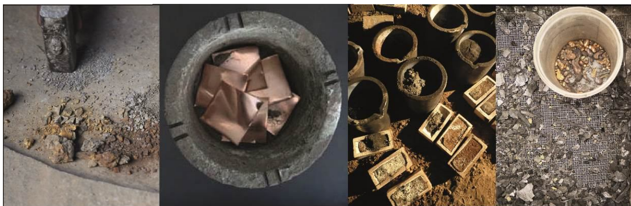
Fig. 2 : préparation du minerai, préparation des tôles de cuivre, du charbon et du minerai dans un creuset, creusets et lingots après coulée, dépouillement et tri des billes métalliques et du ciment restant (Photos N. Méreau, E. Lebon, A. Stevaux).
