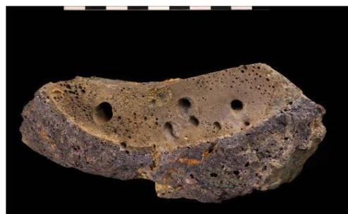
Figure 4 : scories d'élaboration du laiton, complète ou attenante à la paroi du creuset, photo R. Gilles et L. Baty, © SPW-DGO4.
