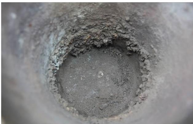
**Figure 10 : scories au-dessus du bain métallique restées en place, grand creuset.**
