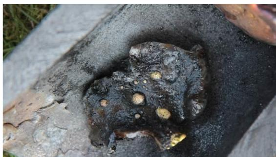
**Figure 13 : billes de laiton prises dans la scorie vitreuse, photo N. Méreau**
