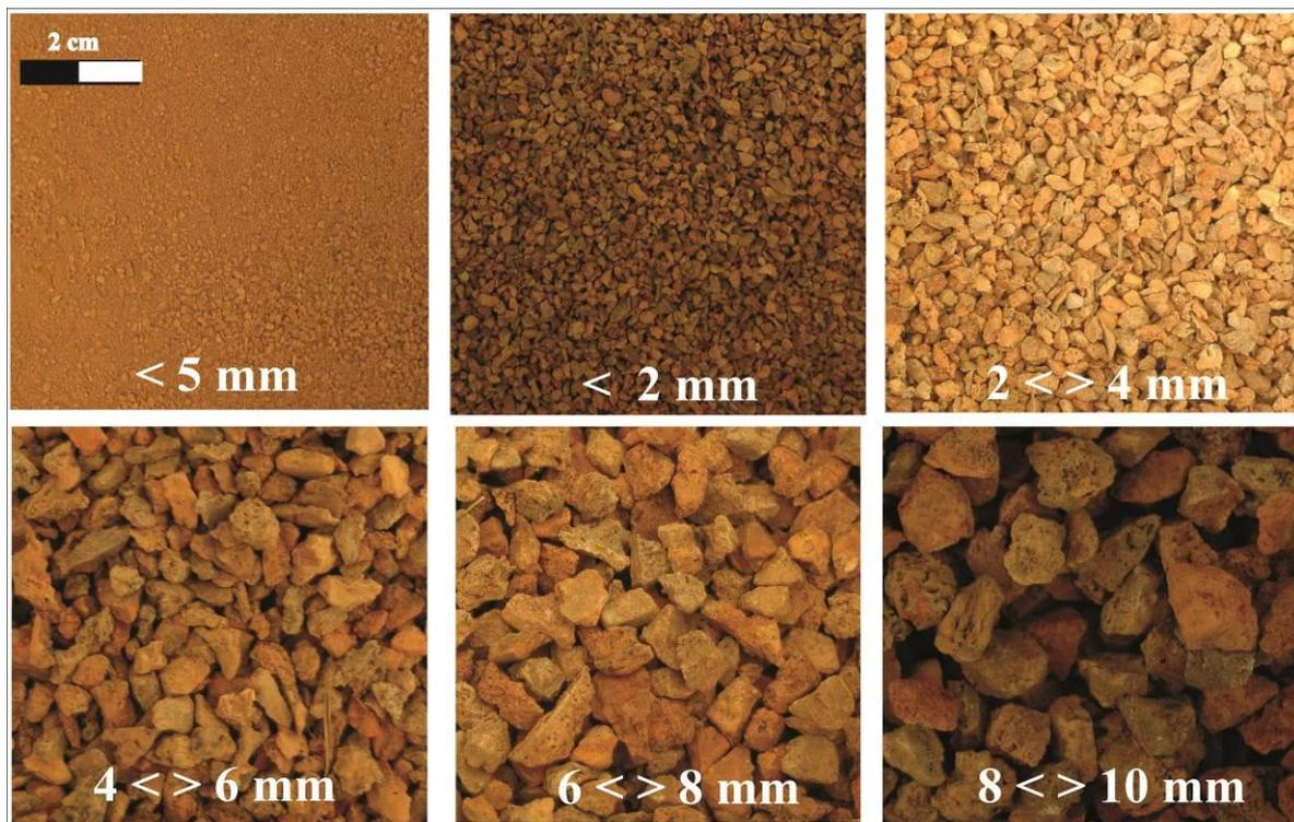
Figure 7 : fractions granulométriques de calamine broyée provenant de Wiesloch (Allemagne).
