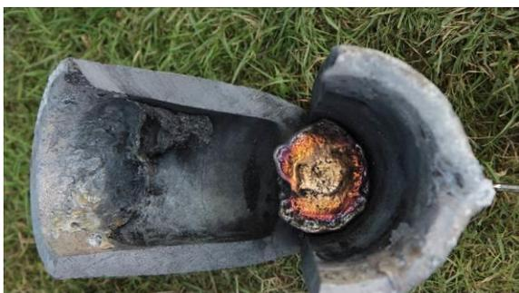
**Figure 12 : scories vitreuses et laiton en place dans le creuset découpé, photo N. Méreau**
