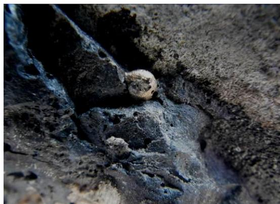
**Figure 11 : bille de laiton prise dans la vitrification de la scorie, grand creuset.**
