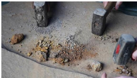
Figure 4 : broyage de la calamine, juillet 2012, Photo N. Méreau
