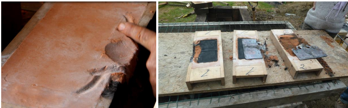
Figure 17 : à gauche, moule au sable, création des événements et de la verse (Photo N. Méreau). À droite, démoulage de deux ébauches de bronze coulées au sable (Photo M. Fays).
