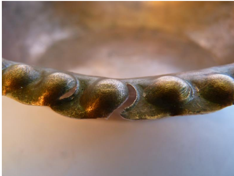
Figure 11 : déchirure lors de l'emboutissage du bord perlé, forme n°2 (photo M. Fays).
