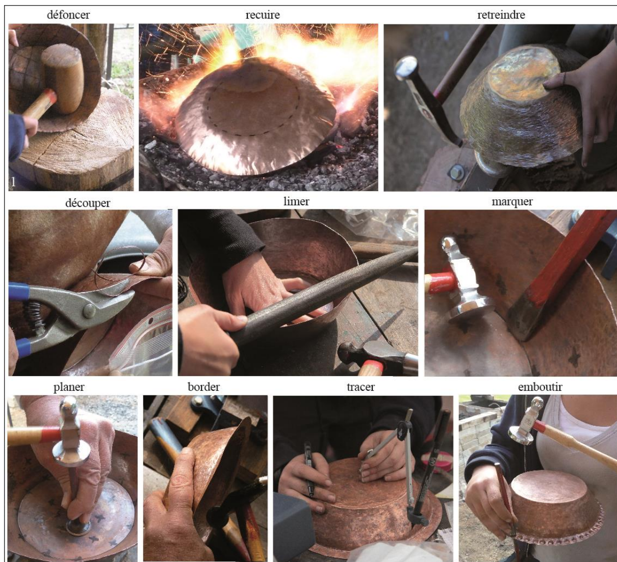
Figure 3 : étapes et gestes de la fabrication d'un bassin martelé (photos M. Fays, N. Méreau, L. Saussus)
