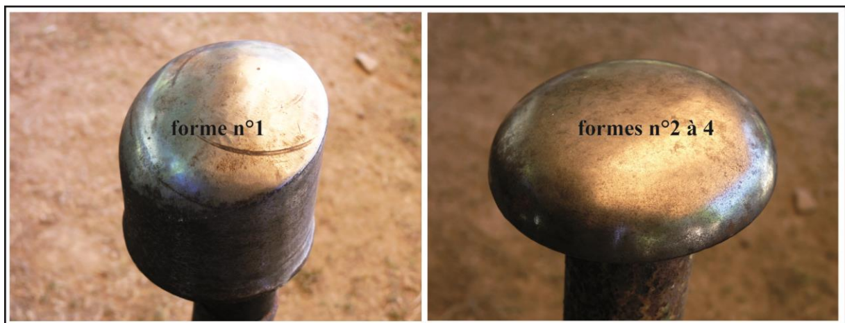
Figure 7 : à gauche, tas n°1 utilisé pour la forme n°1 et à droite, tas n°2 pour les formes n° 2 à 4. (Photos L. Saussus)
