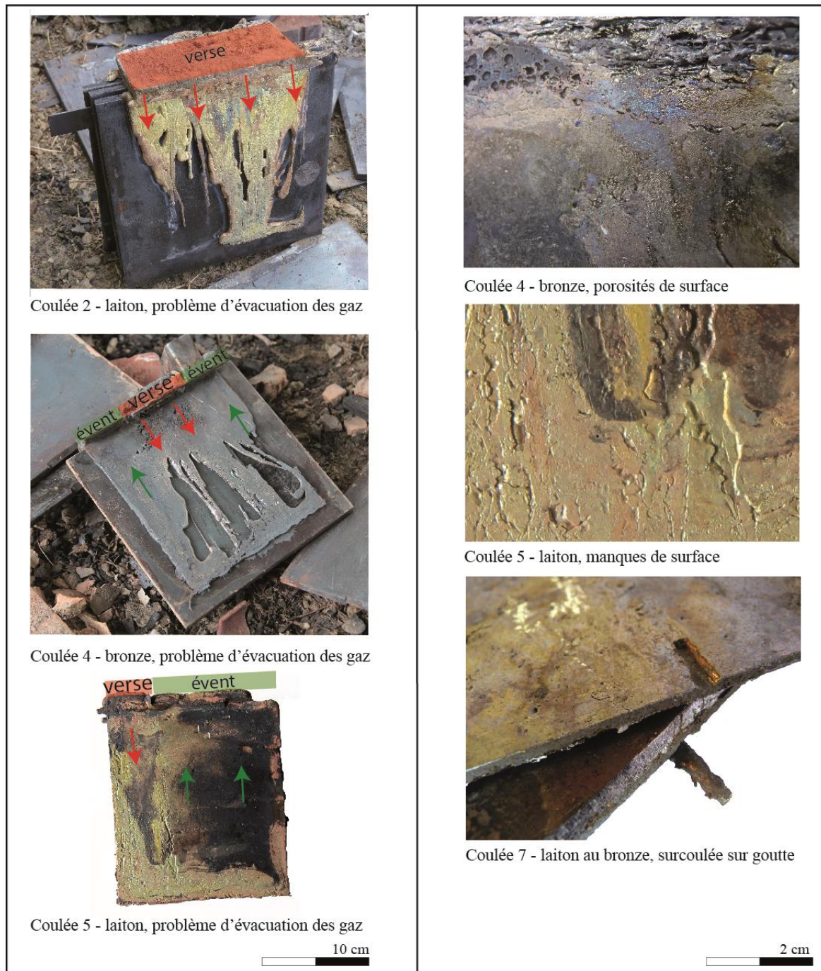
Figure 15 : défauts de fonderie (Photos coulées 2,4, 7 L. Saussus ; coulée 5 N. Méreau)
