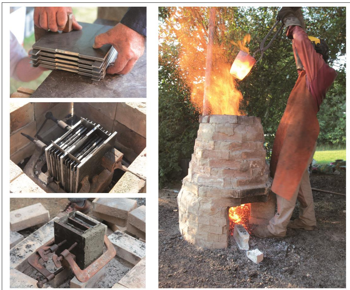
Figure 14 : assemblage du moule, moule assemblé dans le foyer, moule luté. A droite, sortie d'un creuset moyen du petit four. 1ère coulée (Photos N. Méreau).
