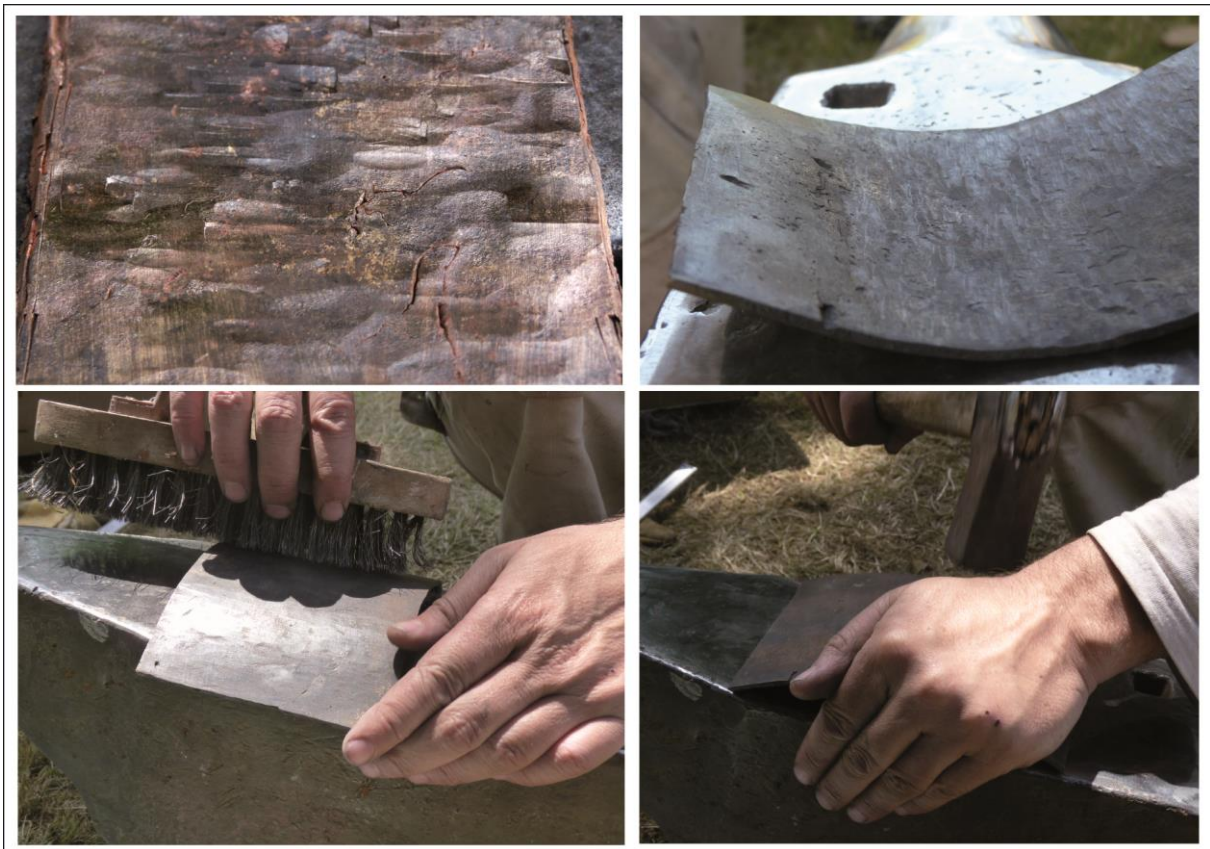
Figure 22 : fissures apparues après l'aplatissement de l'ébauche en bronze suite à la passe n°1. Courbure de l'ébauche en laiton au bronze après recuit, brossage et redressement (photos L. Saussus et M. Fays).
