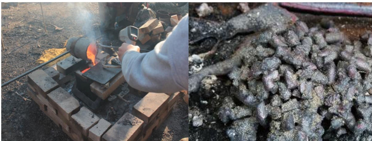
Figure 16 : à gauche, coulée 5, métal remonté du côté de l'évent (Photo N. Méreau). À droite, nuggets de cuivre encore solide à la coulée 1 (Photo L. Saussus).
